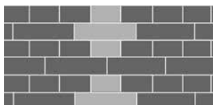
Kreuzverband: Ähnlich wie beim Blockverband wechseln die Kopf- und Läufer-schichten. Die Stoßfugen jeder zweiten Läufer-schicht sind um \frac{1}{2} Steinlänge versetzt. Daraus ergibt sich das charakteristische „Kreuz-Bild“.
