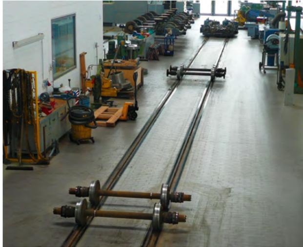
Ein Straßenbahndepot mit arbeitsfreundlichem und leicht zu reinigendem Boden: Röben VIGRANIT® Feinsteinzeug anthrazit, feuerversiegelt, 200 x 100 mm, Oberfläche R12. Sehr hoch belastbar und resistent gegen Öle und Säuren.
