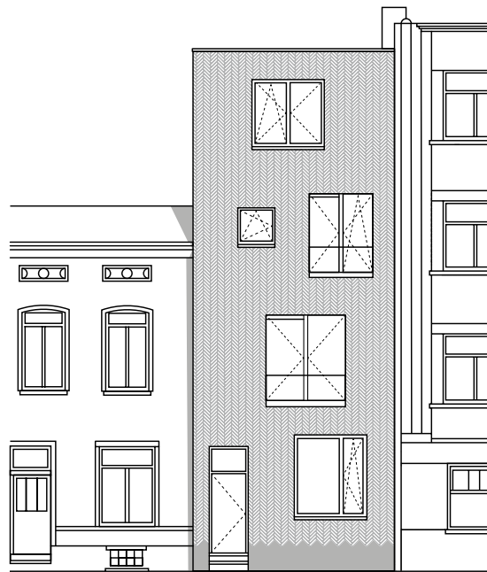
■ Skizzenhafte Frontalansicht der Häuserreihe: In der Mitte ist die um zwei Vollgeschosse aufgestockte Doppelhaushälfte gut zu sehen.
