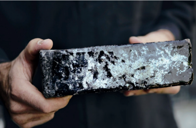
Mineralische Einschlüsse geben den glasierten Backsteinen ihre individuelle Oberfläche.
