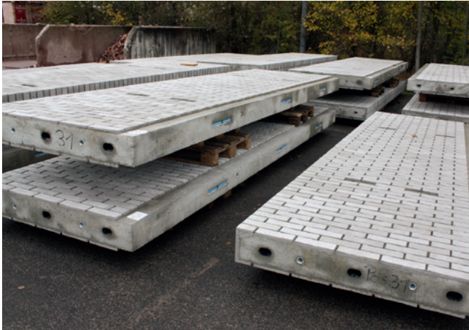
338 Fertigteilelemente wurden für die Pilaster geplant, produziert und über 1.400 Kilometer ausgeliefert.
