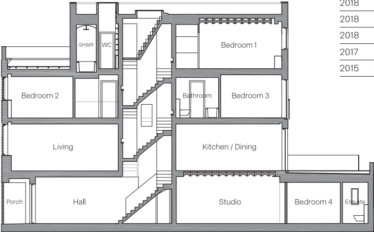
Schnitt durch das Einfamilienhaus
